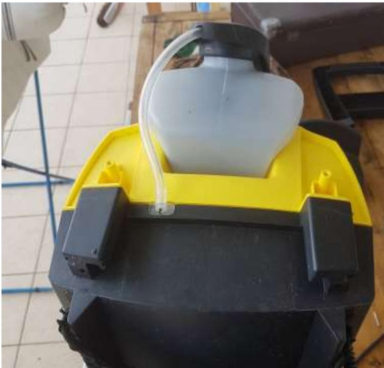
Dann kann mit einem langen Universal-Schraubenzieher und T15 Torx Aufsatz die Schrauben an der schwarzen Rückseite gelöst werden.
