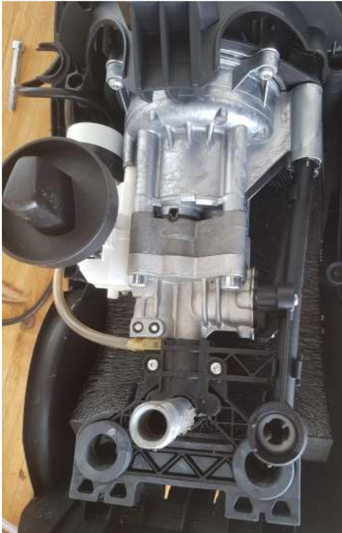
Möchte man die Pumpe komplett ausbauen, muss dieser „Querträger“ (der über die Pumpe liegt) noch entfernt werden. (T15)
