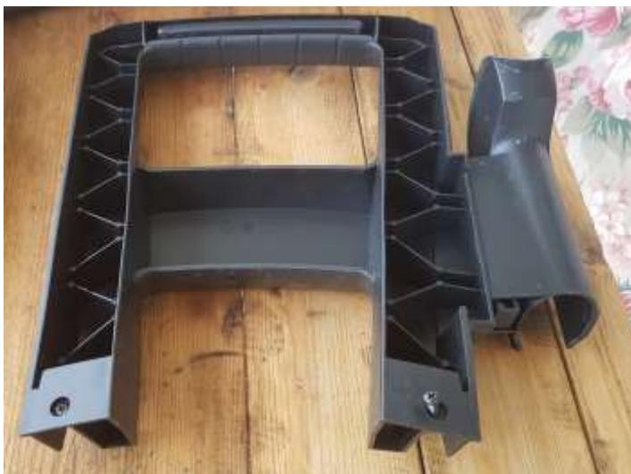
Am Oberteil sieht man jetzt nach dem abgenommenem Griff noch 2 weitere Kreuzschlitzschrauben die entfernt werden müssen
